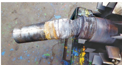
Rys. 7.17. Uszkodzony wał silnika
