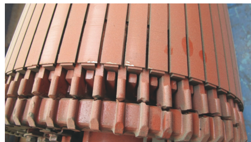
Rys. 7.11. Popękane połączenia prętów wirnika z pierścieniem zwierającym
