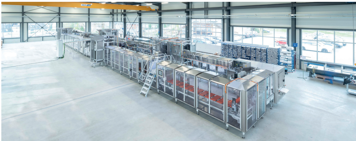
Porządek i łatwy dostęp: modułowa maszyna ConfecPRO ze zdecentralizowanym napędem firmy Bosch Rexroth. Źródło ilustracji: WDS
