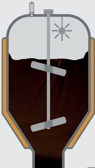
Fot. 5. Pomiar poziomu jest możliwy również w małych zbiornikach i przy wewnętrznych elementach konstrukcyjnych, takich jak mieszadła
