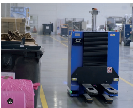
Rys. 7. A – robot manewrujący w zadanych korytarzach roboczych; B – robot AGV pokonujący fragment hali przypominający skrzyżowanie dróg; C – robot AGV z pojemnikiem i w tle widoczny kod QR innego pojemnika transportowego
