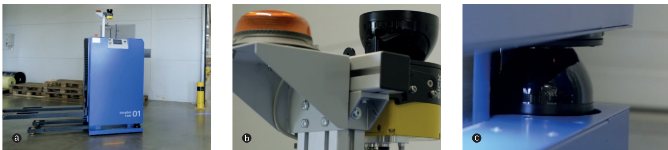
Rys. 4. A – Robot mobilny w trakcie wykonywania misji, na podłodze jest widoczne odbite światło znacznika laserowego; B – widok lidara górnego; C – widok lidara dolnego
