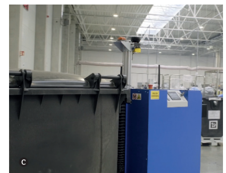
Rys. 7. A – robot manewrujący w zadanych korytarzach roboczych; B – robot AGV pokonujący fragment hali przypominający skrzyżowanie dróg; C – robot AGV z pojemnikiem i w tle widoczny kod QR innego pojemnika transportowego
