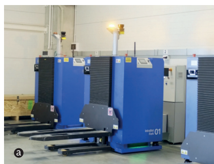
Rys. 3. A - Widok stacji dokującej za robotem „01” oraz roboty „02” i „03” w trakcie ładowania baterii; B - terminal służący do wywoływania misji robotów AGV
