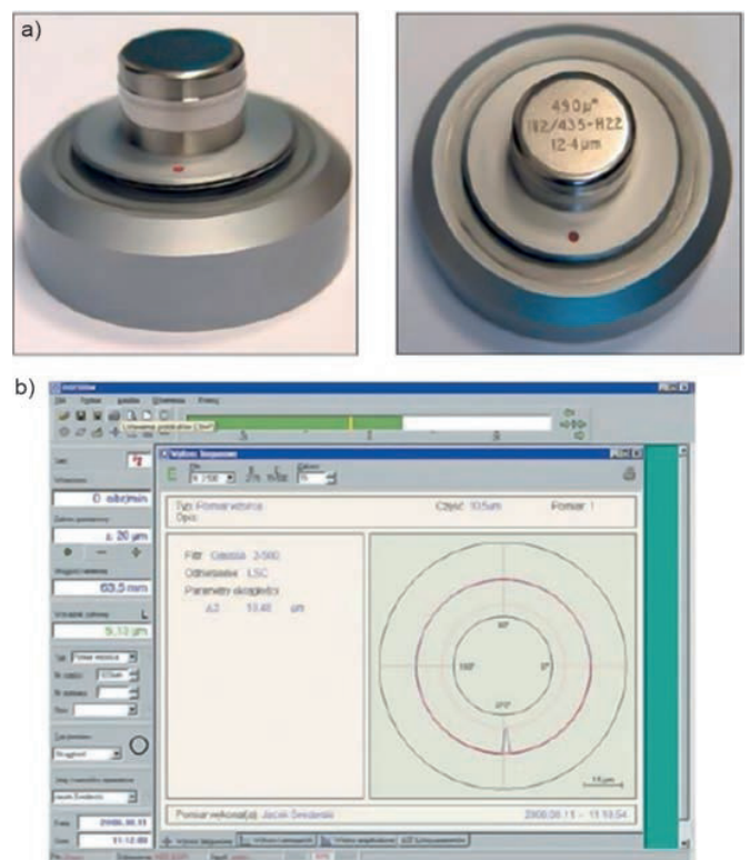
Rys. 2. Wzorec okrągłości: a) widok ogólny, b) profilogram zarysu
