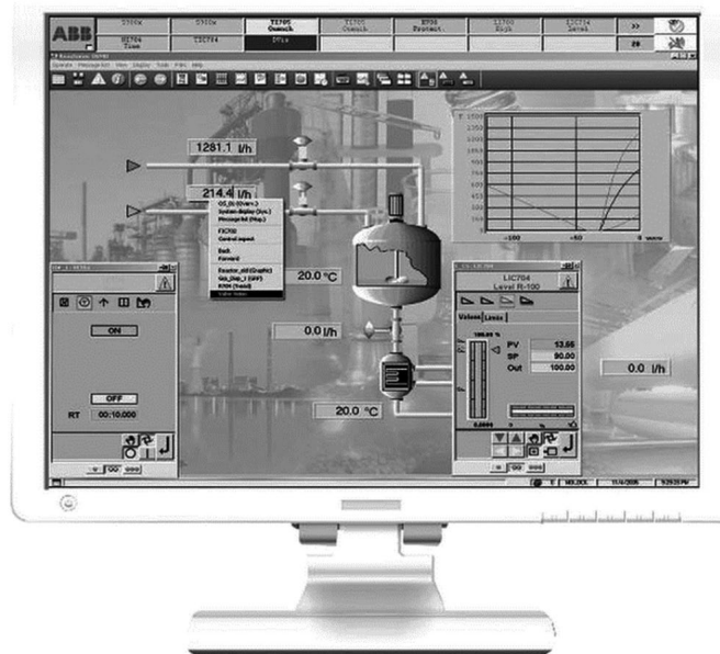
↑ Rys. 7. Przykład wizualizacji procesu w systemie DCS Freelance DigiVis [124]
