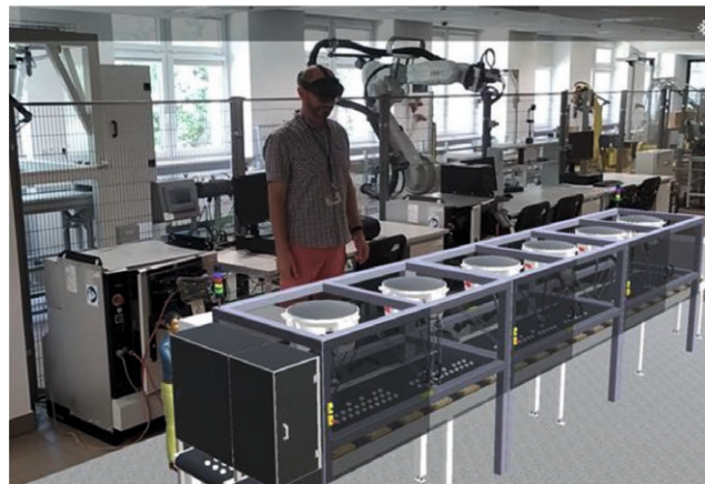
↑ Rys. 24. Ogólny widok stanowiska zrobotyzowanego przygotowanego z wykorzystaniem rozszerzonej rzeczywistości
