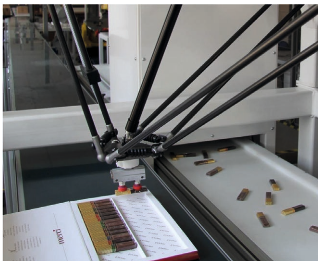
↑ Rys. 16. Robot IRB360 układający czekoladki w kartonie
