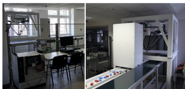
↑ Rys. 8. Stanowisko do sortowania detali z robotem IRB 360 firmy ABB
