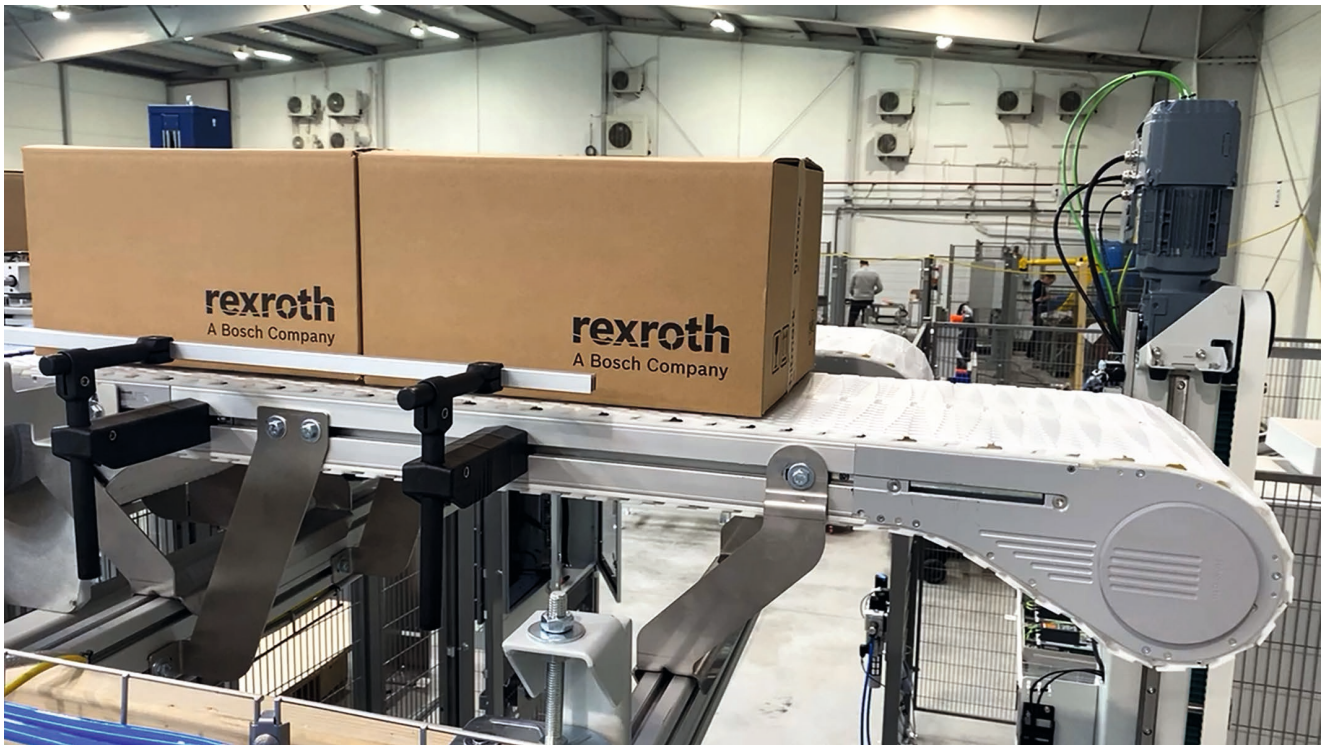
↑ System transportowy VarioFlow 320 z łańcuchem gładkim
