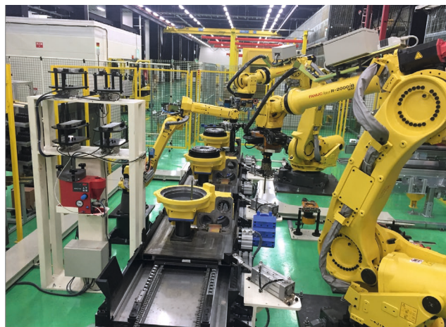
↑ Rys. 1. Montaż przekładni robotów w fabryce FANUC
