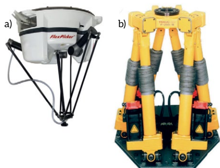
Rys. 10. Roboty z zamkniętym łańcuchem kinematycznym: a) tripod IRB360 firmy ABB; b) heksapod F200i firmy FANUC
