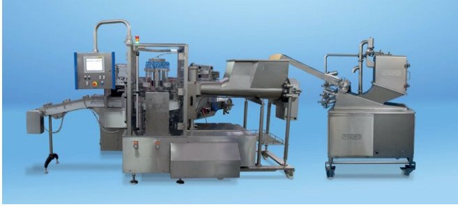
Linia składająca się z homogenizatora oraz maszyny formującej i owijającej kostki
