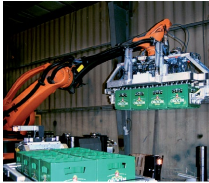
Fot. 2. Robot przenoszący pakiet skrzynek
