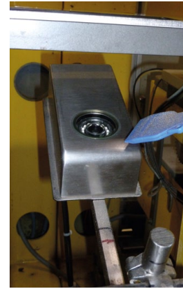
Specjalna obudowa zapewnia ochronę przed pyłem papierowym podczas inspekcji sześciopaków
