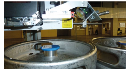
Czujnik wizyjny odczytuje kod DataMatrix, sprawdzając obecność etykiety
