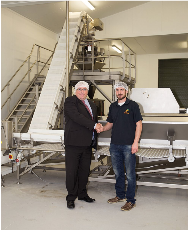
Naważarka 10-głowicowa Ishida serii RS z zasobnikami o pojemności 3 litrów
