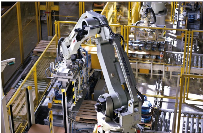
Rys. 8. Stanowisko z robotem Kawasaki ZD250 do paletyzacji wiader z farbą w Fabryce Farb i Lakierów Śnieżka SA w Lubzinie (Źródło: ASTOR)
