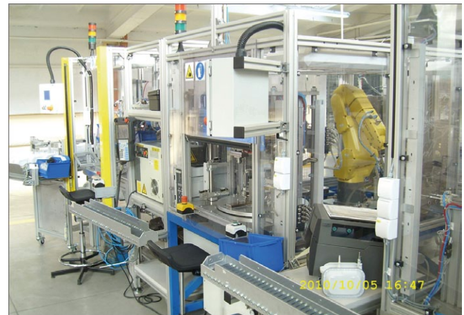
Rys. 9. Montaż instrumentu pomiarowego gazomierza w Aparcie Metrix SA (Źródło: FANUC)
