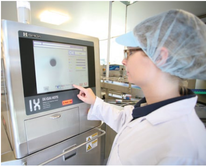
Florida-Eis – ekran sterowniczy systemu inspekcji X-ray, IX Ishida
