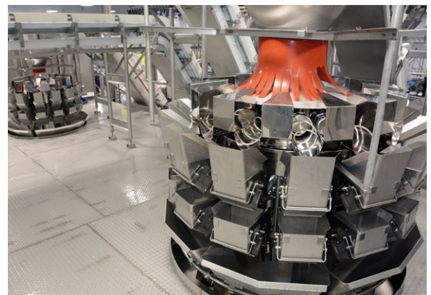
14-głowicowa naważarka z zasobnikami 2- i 5-litrowymi i podajnikami spiralnymi
