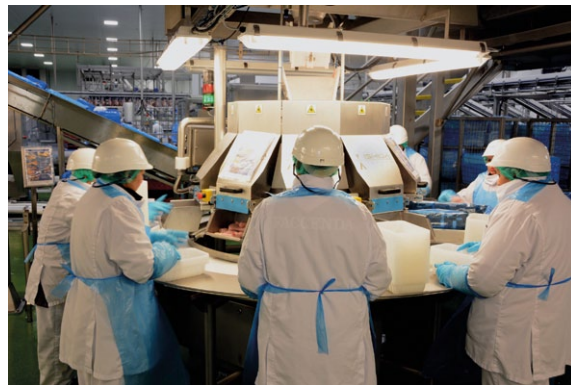
8-punktowy układ dozujący dla porcji ciętych świeżego drobiu
