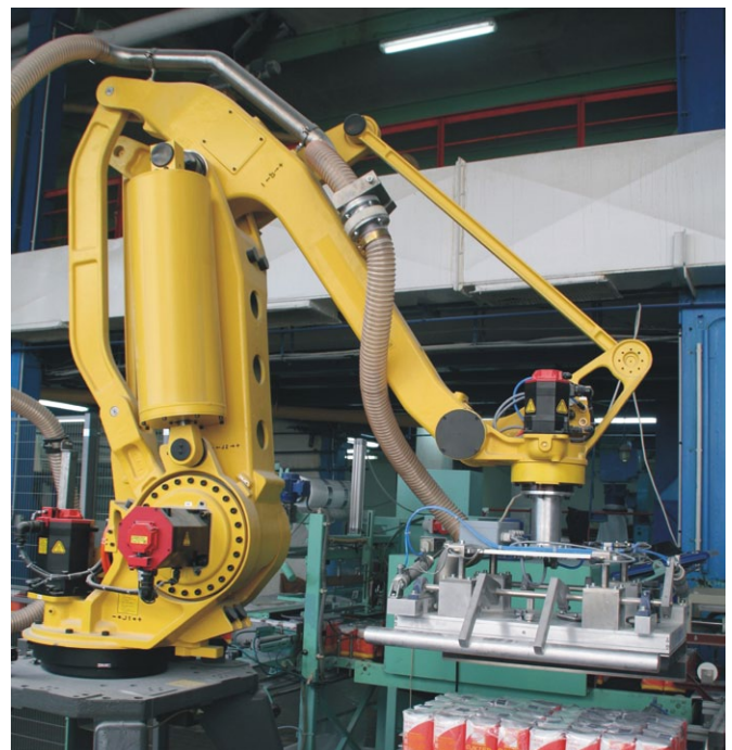
Stanowisko paletyzacji torebek 1 kg z cukrem w pakietach (Źródło: Wikpol)
