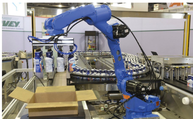
Zautomatyzowana linia pakująca do kartonów butelki z jogurtem
