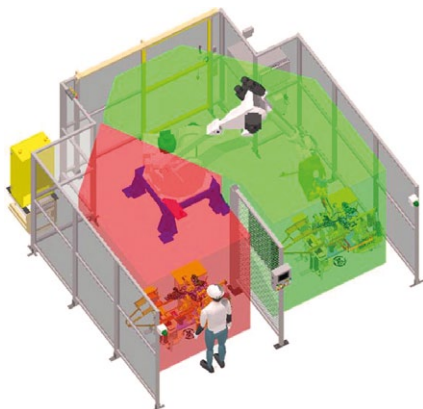
Rys. 11. Monitorowanie obszaru pracy systemem Cubic-S firmy Kawasaki (praca robota dozwolona w strefie zielonej, zabroniona w strefie czerwonej)
