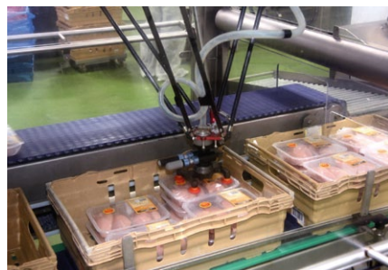
Automatyczne upakowywanie gotowych tacek w skrzynkach Euro
