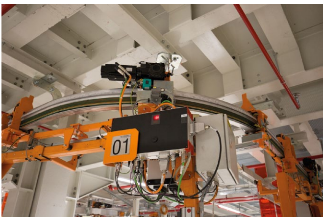
Fot. 4. Sterownik MOVIPRO® i skrzynka rozdzielcza elektrycznej kolejki podwieszanej linii montażu deski rozdzielczej
