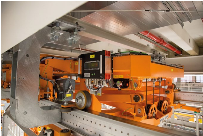
Fot. 3. Kolejka podwieszana z mechatronicznym silnikiem DRC oraz sterownikiem bezpieczeństwa Movisafe HM31B
