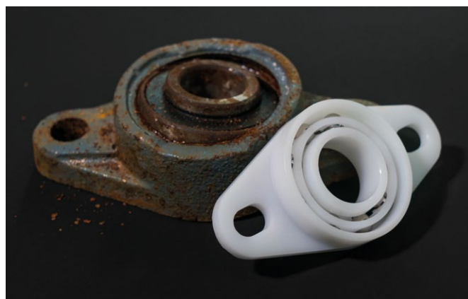
Łożysko kołnierzowe z 2 otworami montażowymi wykonane z metalu i łożysko kołnierzowe xiros wykonane z xirodur B180, po teście z użyciem słonej wody w laboratorium badawczym. Odporne na zużycie łożyska xiros o obliczalnej żywotności nie wykazują oznak korozji lub odbarwienia
