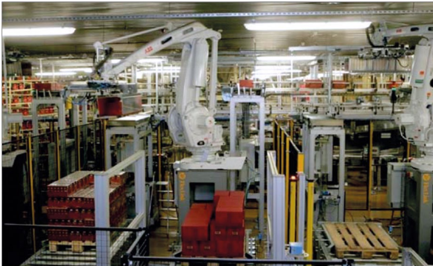
Rys. 13. Stanowisko do paletyzacji kawy w firmie Strauss Cafe Poland
