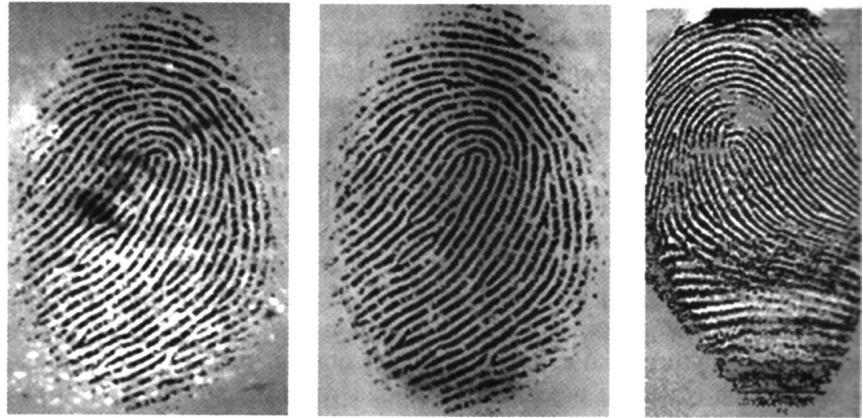
Rys. 3. Obrazy linii papilarnych palca w technologii termicznej (po prawej), pojemnościowej (w środku) oraz optycznej (po lewej)
