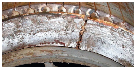
Rys. 38. Uszkodzenie klatki wirnika – pęknięty pierścień zwierający
