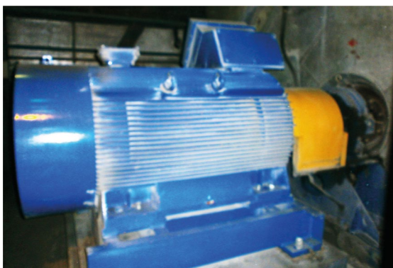
Rys. 1. Silnik Sf560Y6-E 1000 kW, 1483 obr./min, 6 kV
