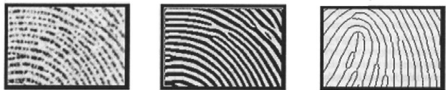
Rys. 8. Od lewej: obraz linii papilarnych uzyskany ze skanera, po podniesieniu kontrastu oraz szkieletowy
