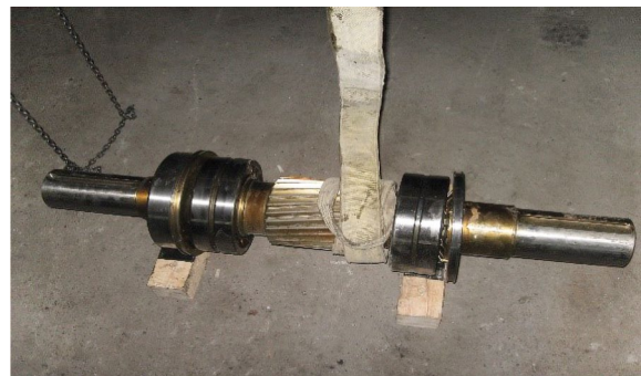
Rys. 27. Wał szybkoobrotowy przekładni napędu głównego młyna cementu z uszkodzonym łożyskiem
