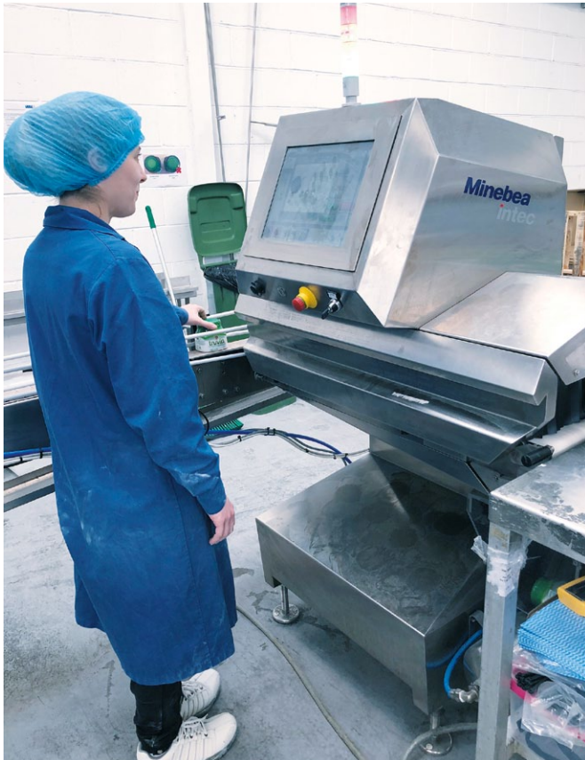
Rentgenowski system inspekcji Dylight firmy Minebea Intec w trakcie eksploatacji w fabryce HCP Health Care Products Ltd.
