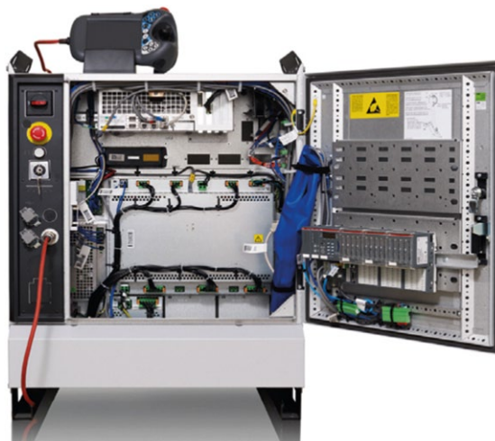
Rys. 4. Kontroler IRC5 ze sterownikiem AC500 firmy ABB (montaż na drzwiach)
