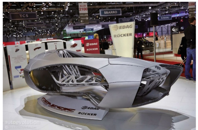
Rys. 3. Samochód Genesis firmy EDAG, w którego projektowaniu wykorzystano optymalizację projektowania części
