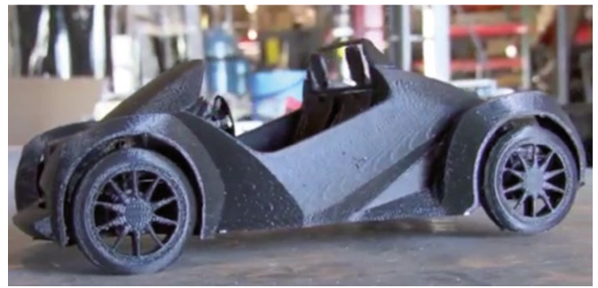
Rys. 2. Wydrukowany w 3D samochód Strati firmy Local Motors
