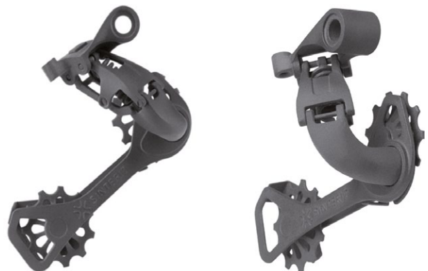
Rys. 4. Dwa różne obrazy wydrukowanego w 3D modelu przekładni rowerowej pokazujące ruchomość jej fragmentów
