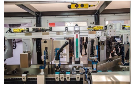
Fot. 3. Koncentratory zabezpieczeń IO-Link i elementy układu bezpieczeństwa (żółte) firmy Balluff gwarantują bezpieczną pracę stacji napędzanych różnymi metodami
