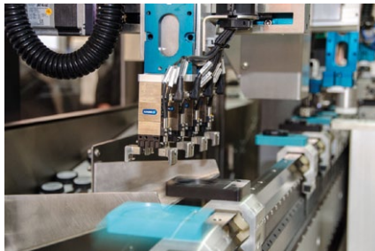
Fot. 5. Niekończący się mechaniczny transport liniowy – mechaniczne uchwyty można szybko ustawić w dowolnym położeniu
