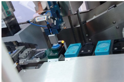
Fot. 4. System detekcji, korzystający z funkcji rozpoznawania obrazu przesyłanego z kamer, sprawdza właściwe ustawienie pojemników
