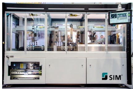
Fot. 1. Układ SIM i system kontroli z jednostką operacyjną (po prawej) oraz centralną jednostką obliczeniową (po lewej)
