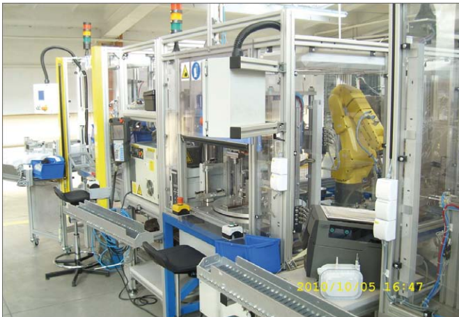
Rys. 9. Montaż instrumentu pomiarowego gazomierza w Apator Metrix SA (Źródło: FANUC)
