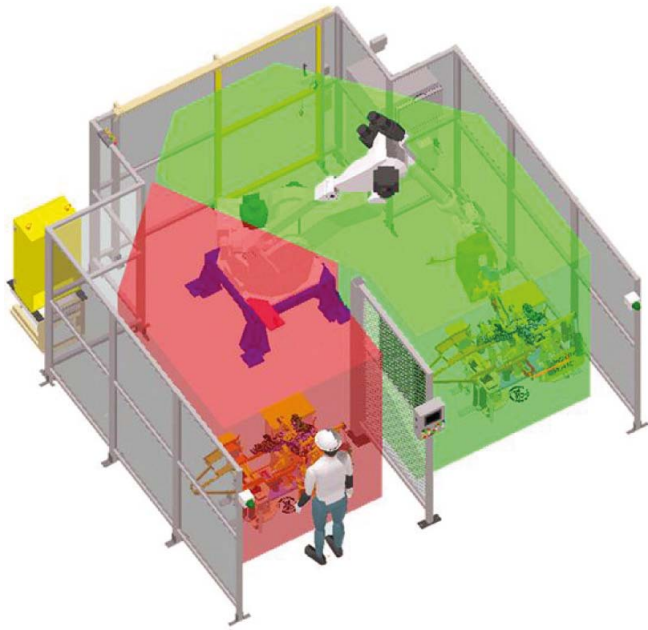
Rys. 14. Symulacja systemu bezpieczeństwa Cubic-S firmy Kawasaki
