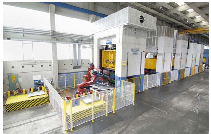
Rys. 8. Linia pras w tłoczni obsługiwana przez roboty COMAU
