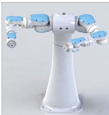
Rys. 2. Sterowany kontrolerem DX100 robot SDA10D firmy YASKAWA
