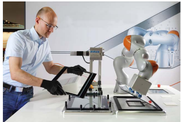
Rys. 16. Robot firmy KUKA precyzyjnie układający szklane panele
