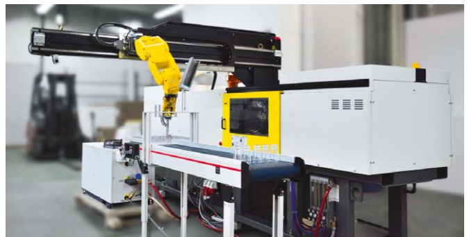
Rys. 12. FANUC Roboshot wraz z robotem LR Mate 200iD zainstalowanym na dodatkowej osi
