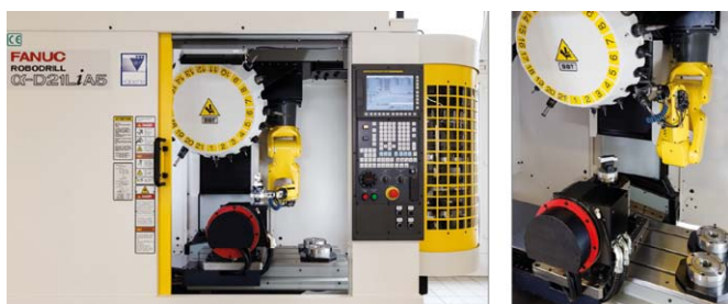
Rys. 4. Robot FANUC LrMate 200iD zainstalowany wewnątrz centrum obróbczego Robodrill (Źródło: FANUC)
