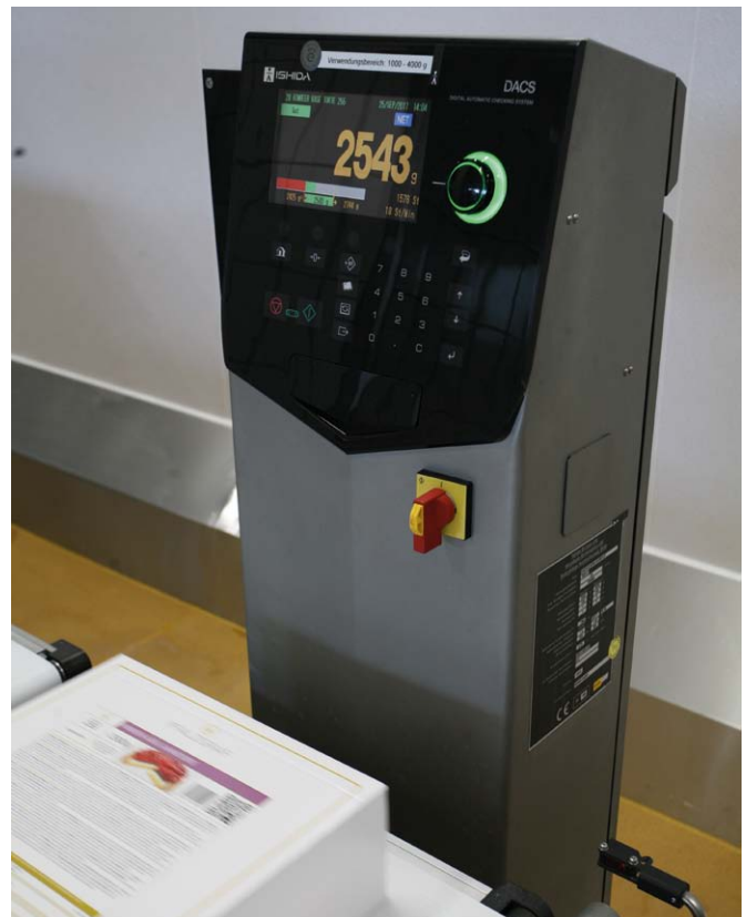
Widok na wagę kontrolną DAC5 Ishida w fazie cyklu roboczego. Kontrola jednego z produktów flagowych Pfalzgraf Konditorei. Test wagi końcowej
