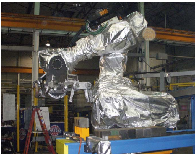
Rys. 10. Robot KUKA KR1000 przystosowany do pracy w wysokich temperaturach (Źródło: http://robotworld.com )
