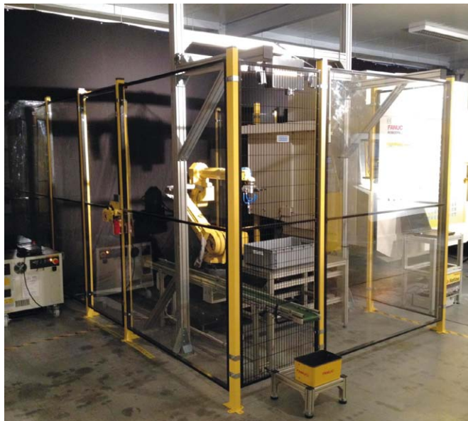
Rys. 1. Robot FANUC M-20iB zainstalowany na zewnątrz centrum obróbkowego Robodrill
