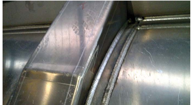
Zastąpienie spawania jednościgowego dwoma ściegami prostymi
