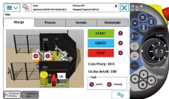
Rys. 13. FlexPendant firmy ABB z aplikacją dla operatora opracowaną w programie ScreenMaker (Źródło: opracowanie własne na podstawie RobotStudio)
