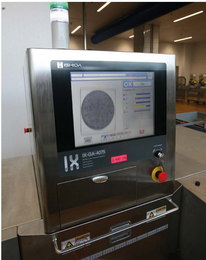
Końcowa stacja kontroli jakości z zastosowaniem systemu detekcji X-ray IX-GA 4075 Ishida. Widok panelu sterowniczego z podglądem produktu i satysfakcjonującym wynikiem badania
