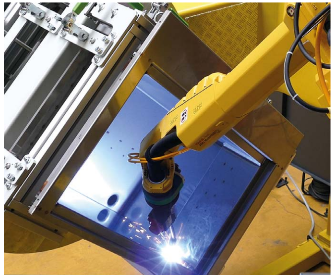
Zrobotyzowane spawanie stali nierdzewnej
