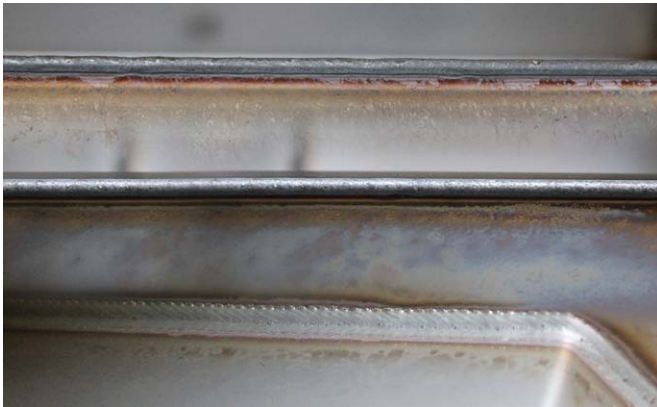
Spawanie stali nierdzewnej metoda MIG – przykładowe spoiny
