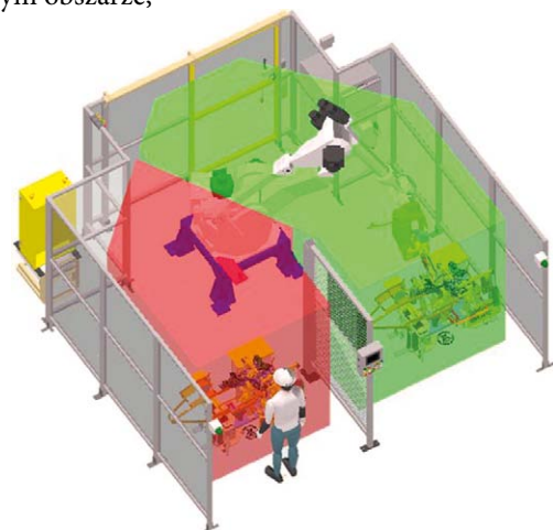
Rys. 11. Monitorowanie obszaru pracy systemem Cubic-S firmy Kawasaki (praca robota dozwolona w strefie zielonej, zabroniona w strefie czerwonej) (Źródło: ASTOR)
