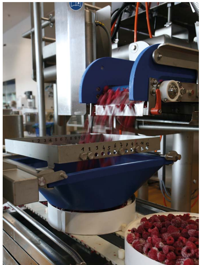
Rzut na układ napelniania. Precyzyjnie zadana porcja wkładu produktowego trafia na ciasto
