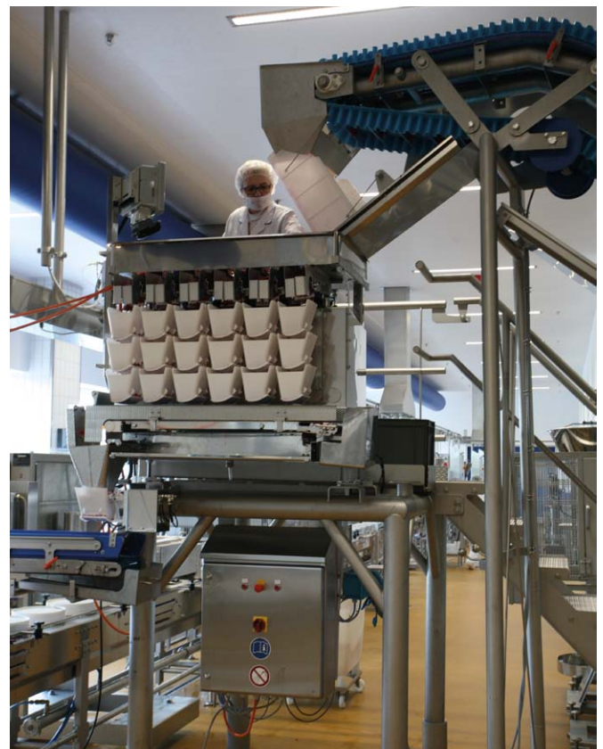
Naważarka wielogłowicowa FFW Ishida w fazie produkcyjnej. Widok systemu 6-głowicowego
