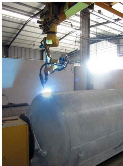
Spawanie zbiornika ze stali nierdzewnej
