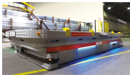
Przykład zastosowania kastomizowanego wózka AGV firmy SEW-Eurodrive dla producenta profili aluminiowych firmy Final Sp. z o.o.
