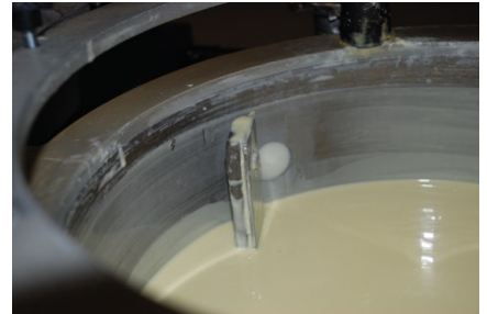
Czujnik pojemnościowy SMARTLevel bezbłędnie wykrywa poziom czekolady bezpośrednio przez plastikową tuleję umieszczoną w ścianie kadzi
