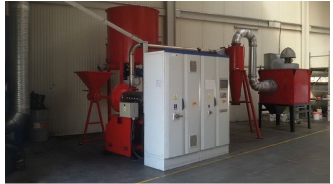
Rys. 2. Stanowisko badawcze naddźwiękowego młyna tarczowego
