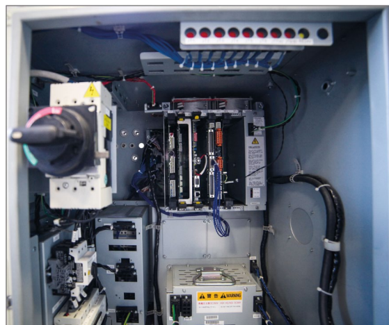
Rys. 6. Wnętrze kontrolera serii D
