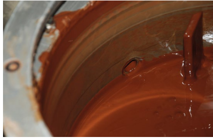
Poprzednie rozwiązanie: pomiar poziomu przez otwór wywierony w ścianie kadzi
